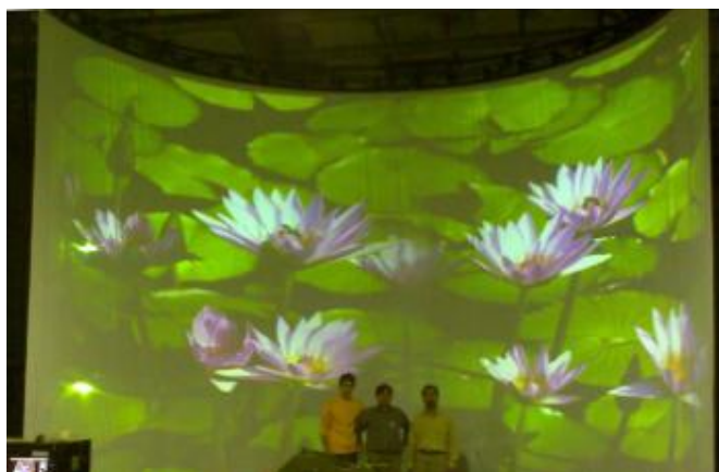
تصویر تولید شده با چهار پروژکتور بر روی پرده استوانه با ارتفاع ۶ متر
